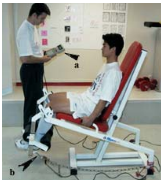
Figure 9 : le travail isométrique peut se quantifier avec un dynamomètre avec un boîtier (a) et une jauge (b) (« ergometer » Globus italia)
